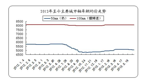
截止 2013 年 5 月末,全国 GCR15 Φ50MM 连铸不退火材均价 5040 元/吨,较上月末下跌 75 元/吨;GCR15 Φ100MM 模铸退火材均价为 8068 元/吨,较上月持平;华东地区 GCR15 中规格热轧不退火材 4550-4800 元/吨,较上月下跌 150 元/吨;GCR15(100mm)退火材 7800-7900 元/吨,与上月相比持平;中南地区 GCR15 中规格热轧不退火材 4800-5100 元/吨,较上月持平,GCR15(100mm)退火材 7550-7800 元/吨,较上月持平;北方地区 GCR15 中规格热轧不退火材料 4680-4850 元/吨,较上月末下跌 150 元/吨,GCR15(100mm)退火材 8700 元/吨,与前一个月相比持平;西部地区 GCR15 中规格热轧不退火材料 5100-5200 元/吨,较上月持平,GCR15(100mm)退火材 7500-7800 元/吨,与前一个月相比持平。从各地市场资源价格变化情况来看,华东、北方地区热轧不退火材价格变化跌幅较大,中西部地区价格比较坚挺,而退火材价格整体依旧维持平稳格局。
